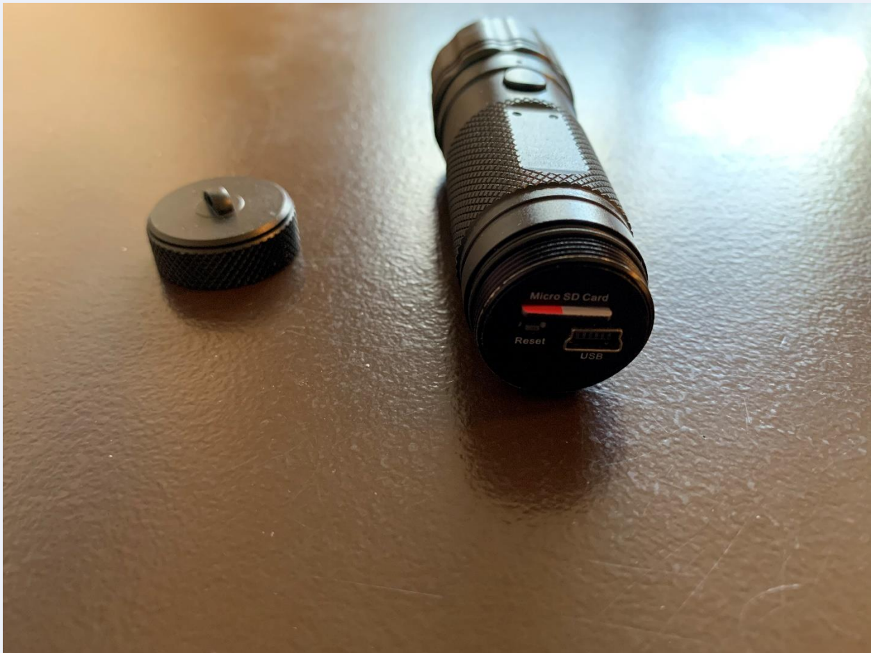
Figure 17 Le GearCam est résistant à l'eau et peut accepter une carte micro SDHC de 16Go.
