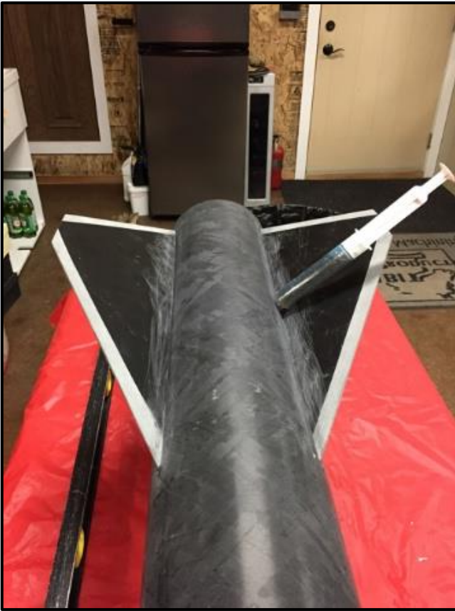
Filets internes injectés dans chaque trou forés dans le tube de surpression avec de l'époxy 'West Systems' mélangé à de la fibre de carbone hachée.
