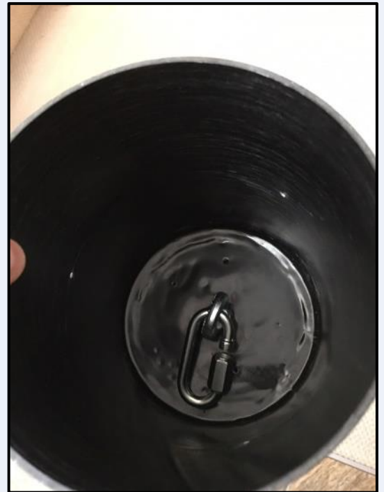
Sur cette photo, une tige filetée \frac{1}{4} " de diamètre fut vissée dans l'embout en aluminium et fixée à un écrou à œil en acier.
