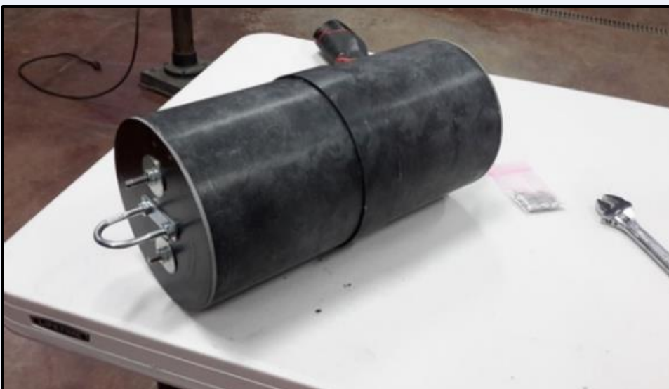
Plaque de l'ogive liée avec de l'époxy dans le coupleur d'ogive.
