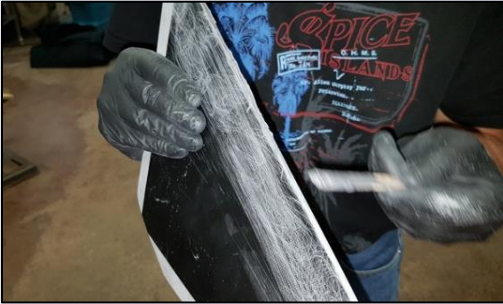
Racines d'aileron badigeonnées avec de l'adhésif 'JB Weld'.
