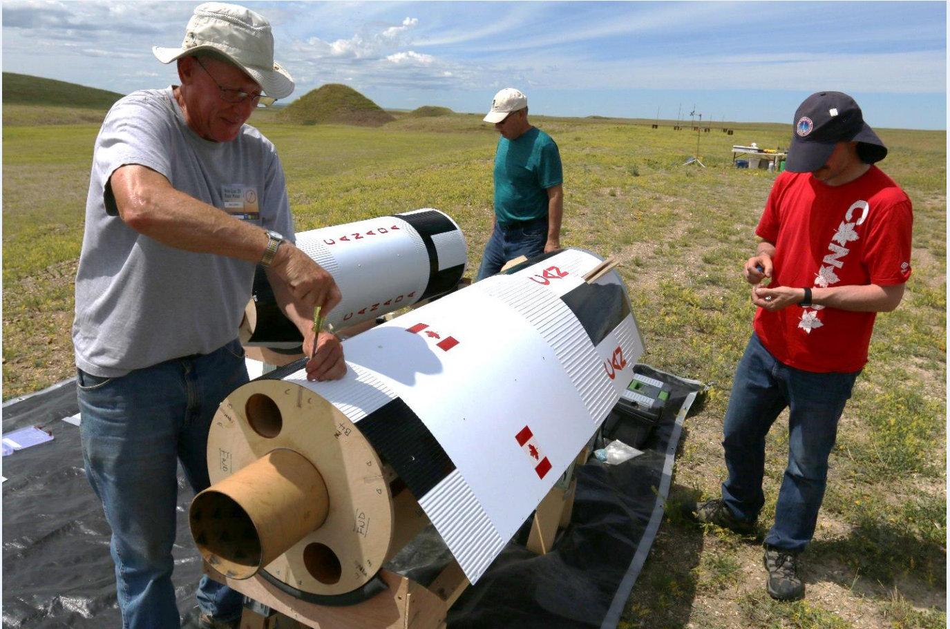
Figure 3 Screwing down the thin Styrene skin, complete with corrugations. Vissage de l'enveloppe de styrène, avec ses décorations en relief
