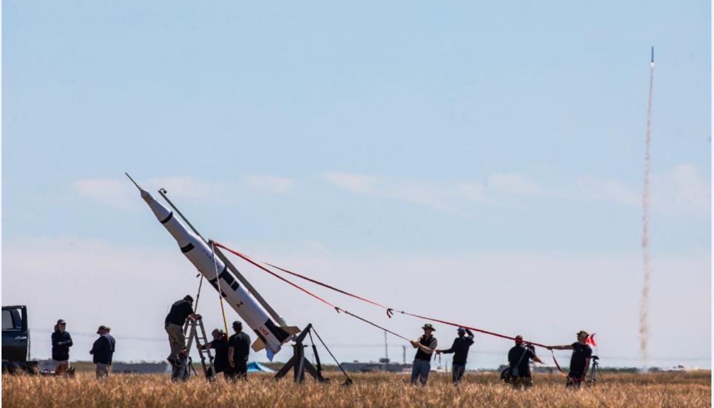
Figure 5 Getting vertical!! Two pushers with two safety lines. Transition vers la position verticale! Deux personnes pour pousser, et deux cordes d'assurance
