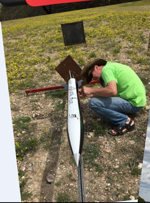
Préparation, installation sur la rampe de lancement, et premier décollage de Skunk Ace à Rock Lake 21, avec un moteur CTI J400SS.
